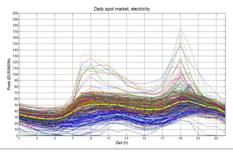
Arbeitsbereich Energieeffizientes Bauen universität innsbruck Grid-Electricity-Cost for RES45 (without PV) for constant (REF00) and variable Electricity-Cost (311 bis 317) with different Control Strategies of Price-Coupling
